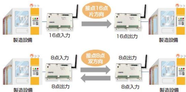
2. 屋内約 300m／見通し約 2,000m まで無線伝送可能・・・標準モードで「通信距離 屋内約 300m」「応答時間 250ms」、ロングレンジモードで「通信距離 見通し 2,000m」に延長可能です。
