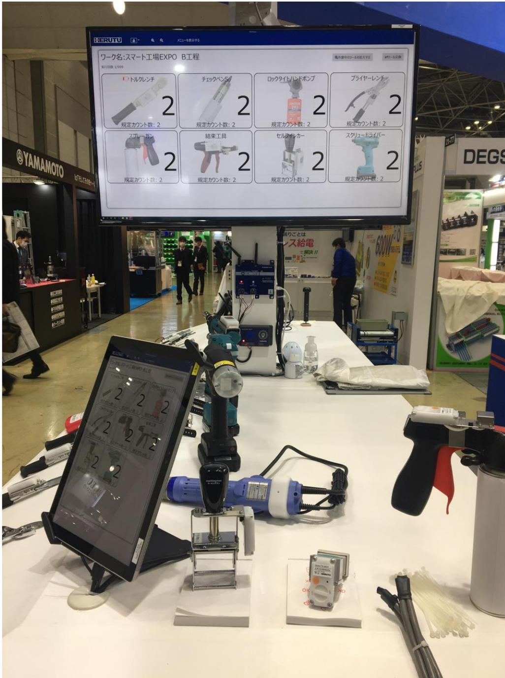
大幅にバージョンアップしたアプリケーション「POKAYOKE plus」を通じて、ポカヨケを総合的に支援するデモンストレーションをいたしました。工具に取り付けたポカヨケ用送信機の電池残量のアラート表示、ポカ発生時に回転灯の点灯や腕時計型受信器「シルウォッチ」への通知等、新しいユースケースをご紹介いたしました。
