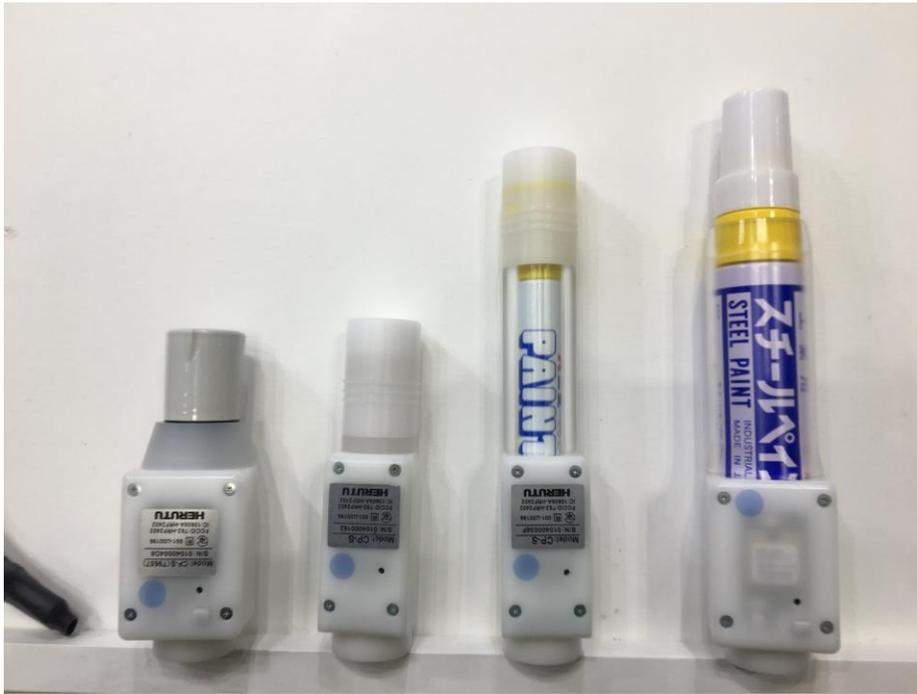
マーキングポカヨケに対応した様々なタイプのペンやスタンプを展示いたしました。今回の展示では、ポカヨケ用送信機「TW-800T」を装着していたスタンプ(下図)に対し、TW-800Tを小型化した新送信機を装着して展示いたしました。このポカヨケ用送信機は電池交換が容易で、メンテナンス性が向上しております。
