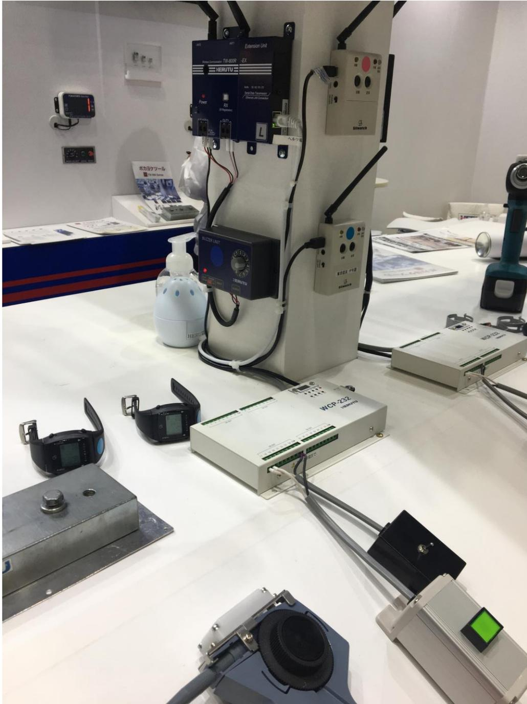
ポカヨケ用受信機の音量を大きくする「ブザーユニット」と、ワーク作業中に製造現場の設備との連携を可能とする「通信ユニット」を初展示いたしました。ブザーユニットは、既存のポカヨケ用受信機に後付可能です。また、8種類の音色を選択できるため、工程（ポカヨケ用受信機）ごとに音色を変更することが可能となります。
