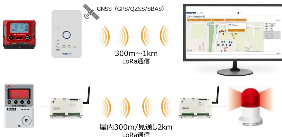
作業者が装着したポータブルガスモニターもしくは作業現場に設置された小型酸素モニターが異常を検知した際、離れた場所にいる監督者や周辺の作業者にリアルタイムにお知らせするシステムを参考出展いたします。
