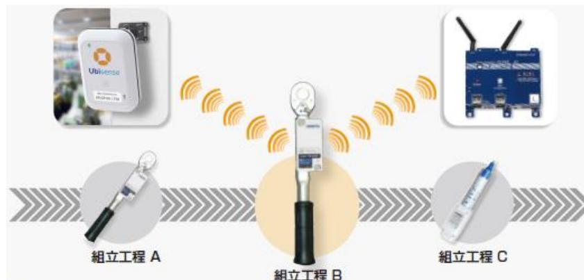
自動車等の組立ラインの各工程において、「作業者は正しい締結工具を用いているか」及び「規定の締結回数通りに、作業者は締結作業を実施しているか」を同時にリアルタイム監視するシステムをご紹介します。
