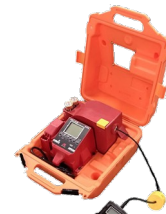
マンホール・ピット作業用 有害ガス検知器 GX-2100 《参考展示》
