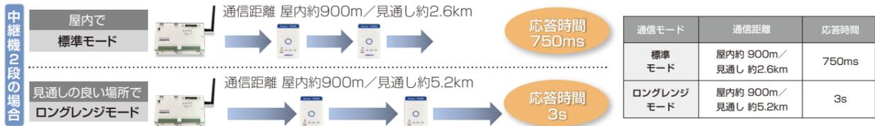
※応答時間とは、「入力端子に信号が入力されてから、通信相手の出力端子から信号が出力されるまでの時間」を意味します。 ※応答時間と通信距離は使用条件により異なります。
