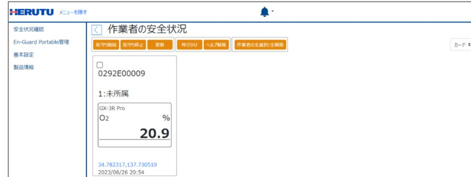
❗ 見守り中は、定期的に「ENP-BT01J」と無線通信を行い、作業員の携帯しているポータブルガスモニターのガス情報と位置情報を取得し、安全の監視を行います。
